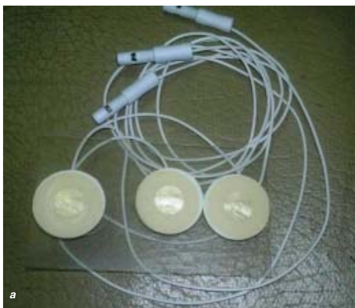
Рис. 3. Внешний вид гидрогелевых (а) и игольчатых электродов (б) для проведения церебрального мониторинга.
