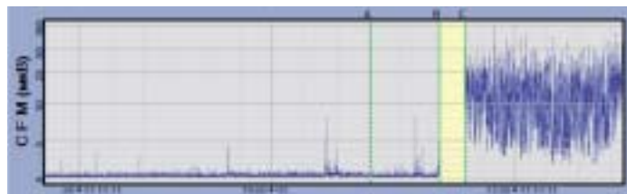
Рис. 8. Влияние межэлектродной дистанции на амплитуду паттерна. (Первоначально электроды были ошибочно зафиксированы на расстоянии 40 мм (норма 75 мм), при этом регистрировался ложный паттерн «изолиния». При обнаружении ошибки и фиксации электродов с дистанцией 75 мм (маркеры В и С) идентифицирован «прерывистый» фоновый паттерн).
