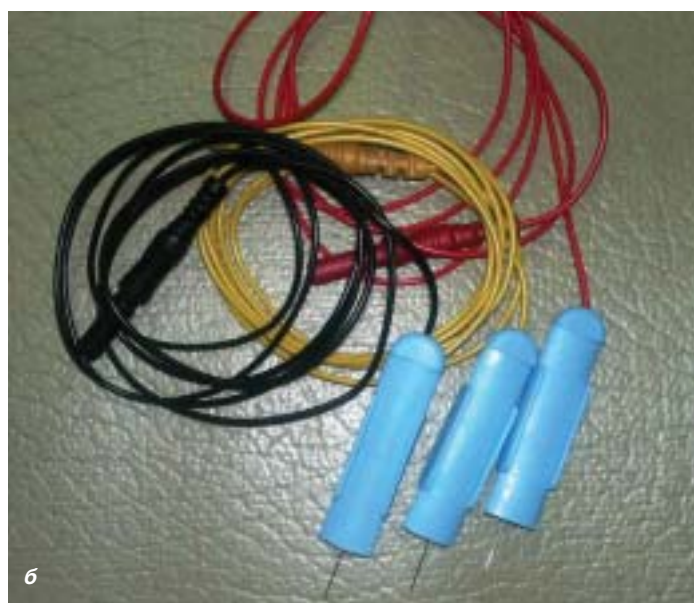
Рис. 3. Внешний вид гидрогелевых (а) и игольчатых электродов (б) для проведения церебрального мониторинга.
